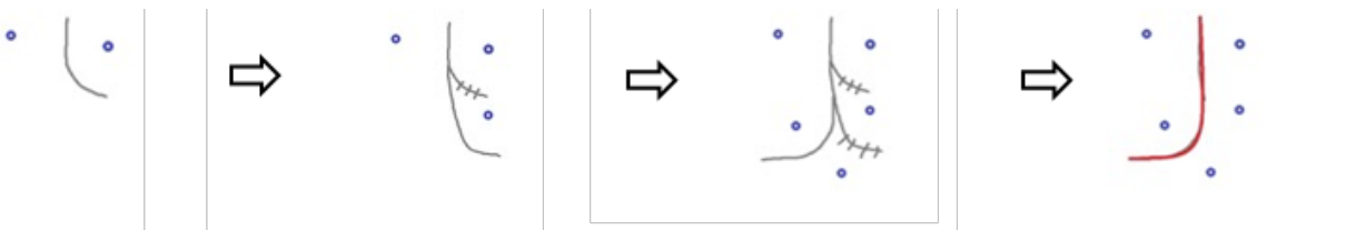
Figure 13 : Processus itératif de délimitation d'unités cartographiques. Le tracé supposé de la limite est esquissé sur le plan de terrain (en gris) puis confirmé en couleur (rouge) une fois que l'unité cartographique est terminée ; les sondages sont indiqués sous la forme de points bleus (d'après la Fig. 5.3 de Legros (1996, p. 134)).
